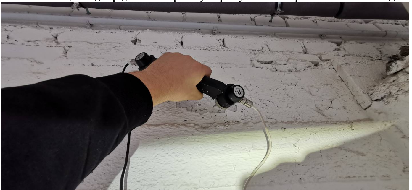
Рис. 4.2.2 Общий вид определения скорости ультразвука в перемычках стен вдоль оси А
