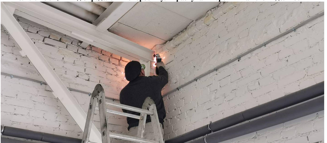
Рис. 4.2.3 Общий вид отбора образцов металла на химсостав
