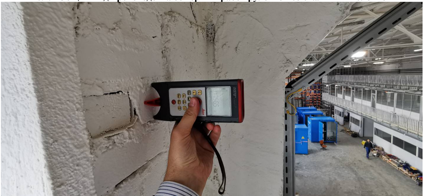
Рис. 2.2 Замер параметров помещений лазерным дальномером
